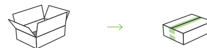
Sjaktel for åpning med rivetape og perforering.
