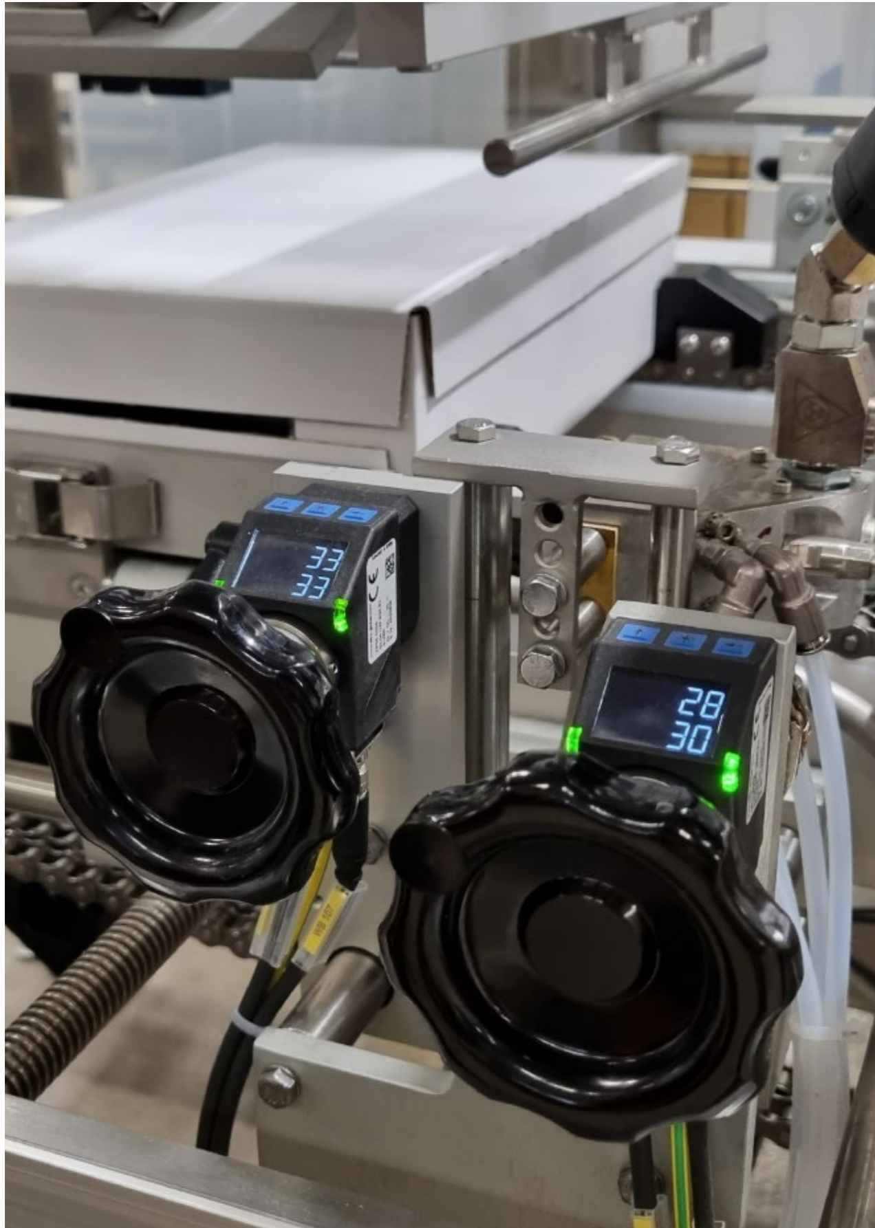
Digital klokke for effektiv omstilling av maskinen.
